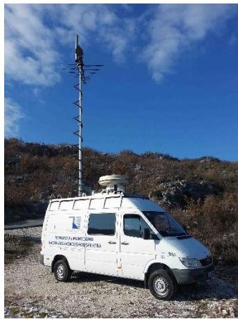
Mobilna kontrolno-mjerna stanica u vozilu Mercedes-Benz® Sprinter
